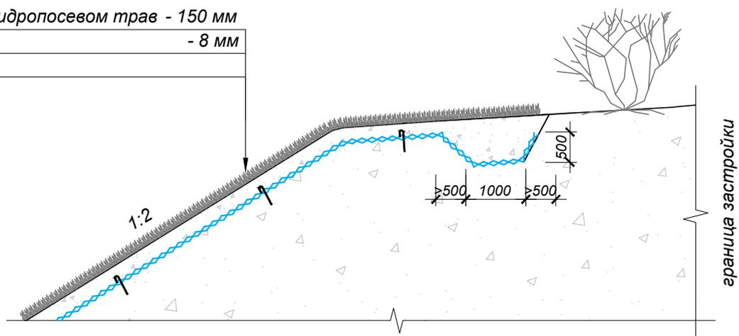
**Гидромат 1D** удерживает грунт от сползания - субстрат засыпается в ячейки дренажного элемента. Корни засеянной травы в плодородном грунте скрепляются с Гидроматом 1D, образуя прочную структуру.
